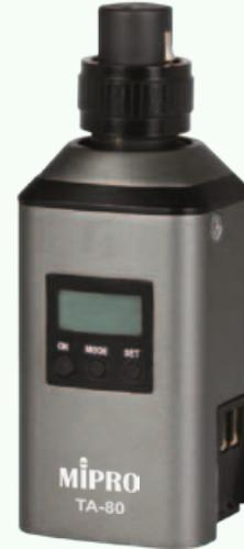
Der TA-80 ist ein kleiner digitaler Sender der direkt an alle Mikrofone mit XLR-Stecker aufgesteckt und betrieben werden kann. Es können sowohl dynamische als auch Kondensatormikrofone verwendet werden. Der Sender verfügt dazu über eine integrierte Phantomspeisung die in Stufen von 0, 12 und 48 V umgeschaltet werden kann und einen Speisestrom von bis zu 10 mA liefert. Bei der Verwendung von dynamischen Mikrofonen kann die Phantomspeisung abgeschaltet werden.
