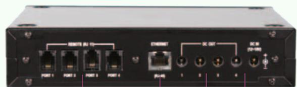
RJ-11 Ports      Ethernet Port      DC Eingang
